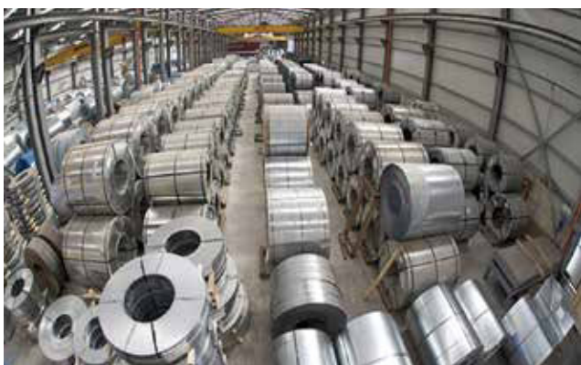
Coils in acciaio zincato tagliati a misura per la produzione FIBRANprofiles
